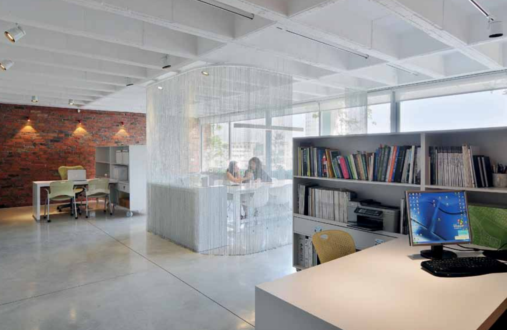
החלל שנוצר אחרי השיפוץ והסרת כל הקירות והתקרות הקלות: פתיחות לופטית, ריצוף בבטון מוחלק, ותקרת הקסטות במופע המקורי כפי שנחשף.
